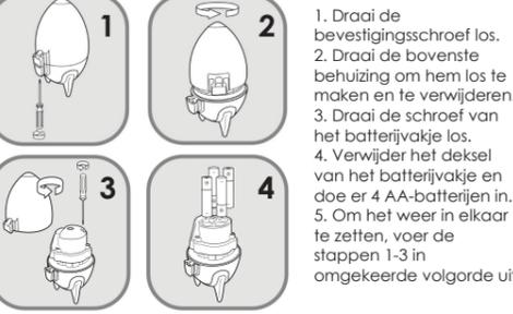
1. Draai de bevestigingsschroef los.
