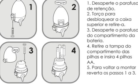
1. Desaperte o parafuso de retenção.
